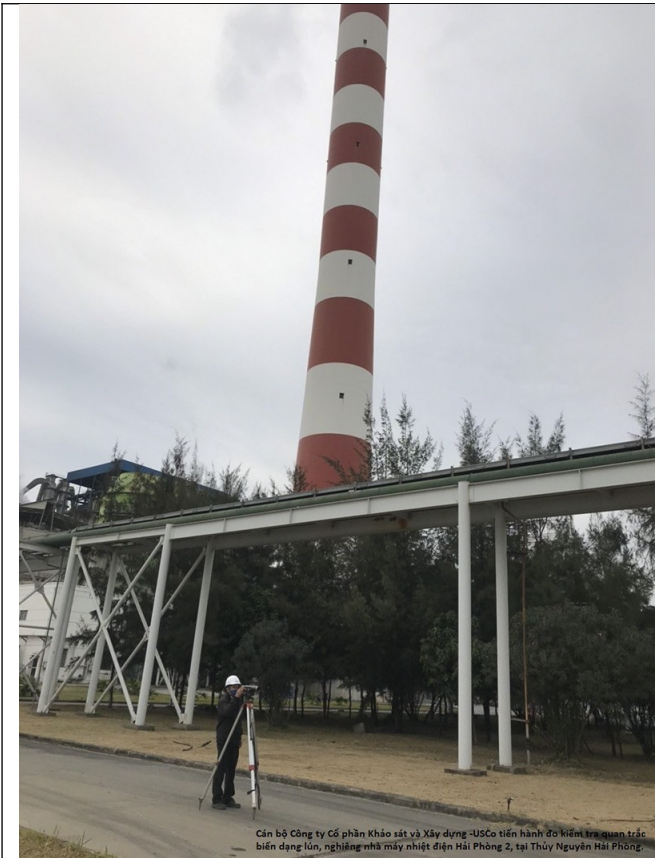
Cán bộ kỹ thuật của Công ty Cổ phần Khảo sát và Xây dựng - USCo đang tiến hành đo kiểm tra quan trắc lún, nghiêng nhà máy nhiệt điện Hải Phòng 2, tại Thủy Nguyên, Hải Phòng.
