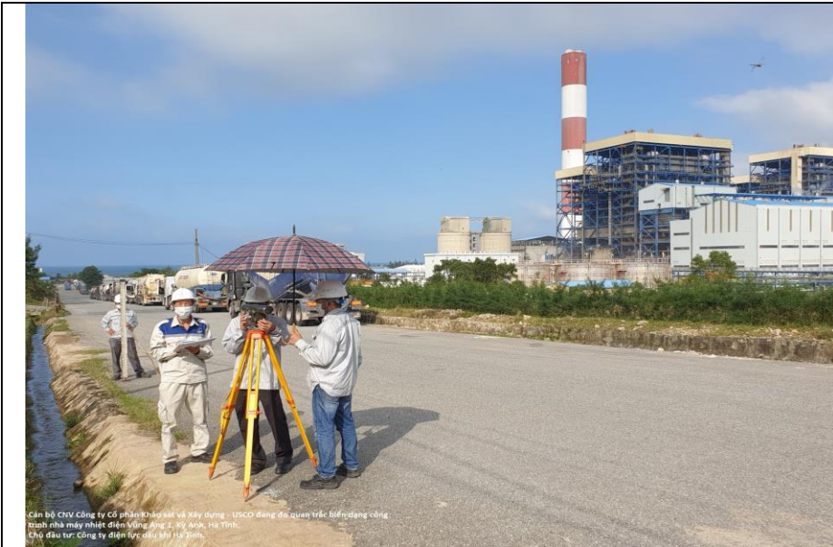
Cán bộ CNV Công ty Cổ phần Khảo sát và Xây dựng - USCO đang đo quan trắc biến dạng nhà máy nhiệt điện Vũng Áng 1, Kỳ Anh, Hà Tĩnh. Chủ đầu tư: Công ty điện lực dầu khí Hà Tĩnh.
