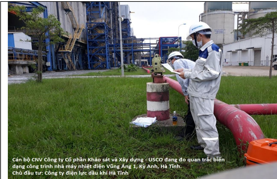
Cán bộ CNV Công ty Cổ phần Khảo sát và Xây dựng - USCO đang đo quan trắc biến dạng công trình nhà máy nhiệt điện Vũng Áng 1, Kỳ Anh, Hà Tĩnh. Chủ đầu tư: Công ty điện lực dầu khí Hà Tĩnh.
